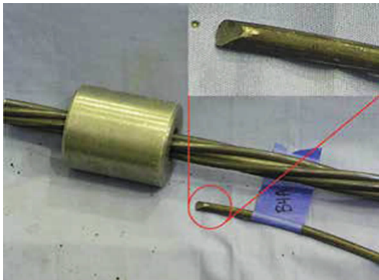
图 24 预应力钢绞线的单丝破断 [89]
