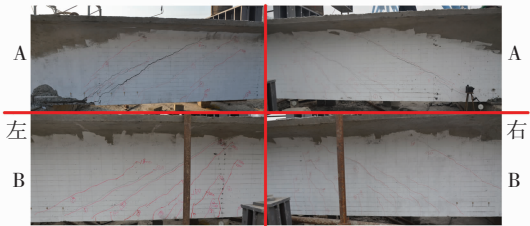
图 3 DT-24 斜截面性能试验
