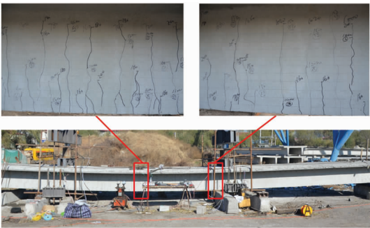
图 2 DT-18T 弯曲性能试验
