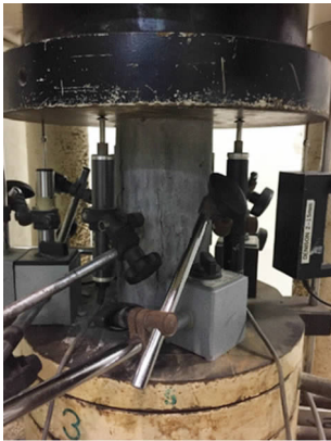
图 2 ULCC 抗压试验装置
