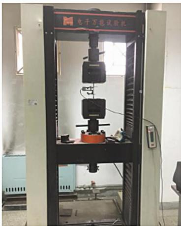
图 5 拉伸试验加载装置
