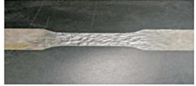
图 2 除锈后试件表面
