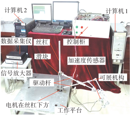
图 14 Bennett 单元阵列可展机构实验台
