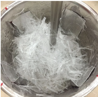
图 9 低转速时纤维状态图
