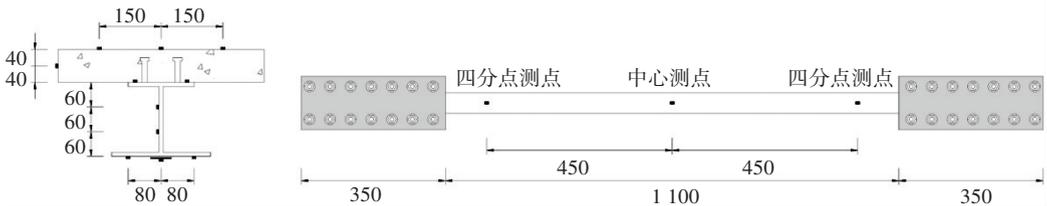
图 3 梁截面和碳纤维板测点布置 (mm)
