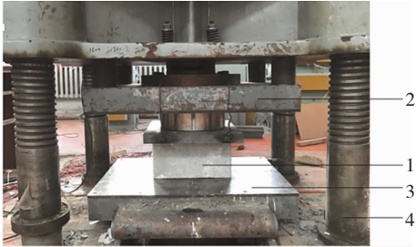
图 5 砌块高温后抗压试验
