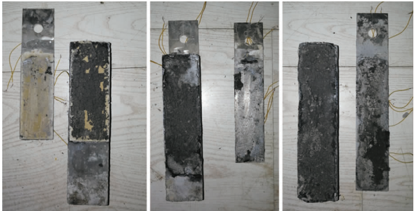
图 6 S 系列试件试验破坏模式
