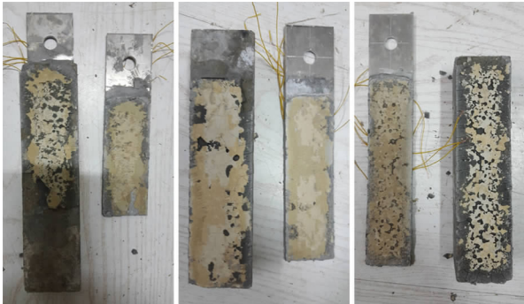
图 5 N 系列试件试验破坏模式
