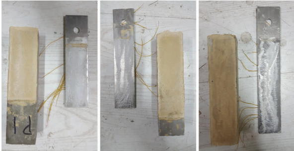
图 4 M 系列试件试验破坏模式
