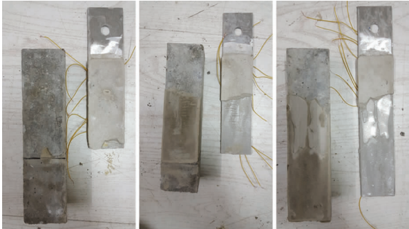
图 3 A 系列试件试验破坏模式
