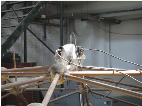
图 4 加速度传感器布置 Fig. 4 Position of acceleration sensors
