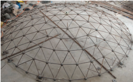
图 1 试验结构 Fig. 1 Test Structure
