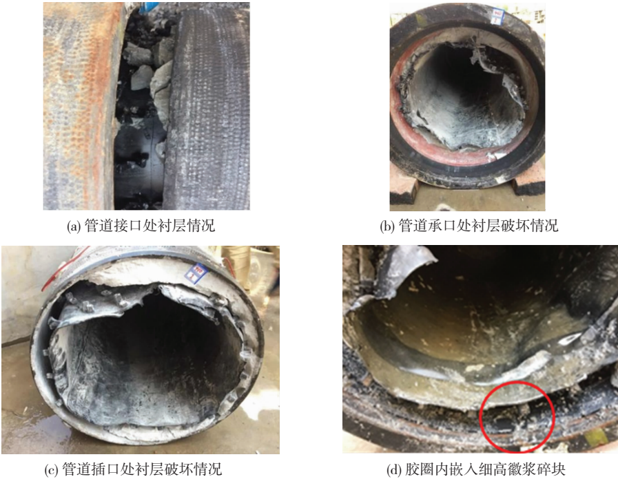
图 10 管道内部衬层变化情况 Fig. 10 Changes of pipeline internal liner
