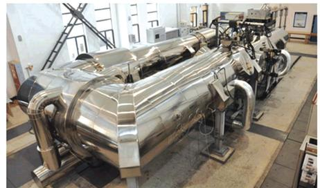
图 14 0.3 m 低温风洞实物图
