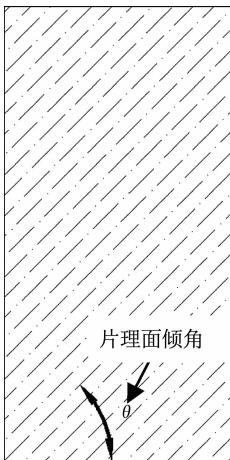
图 3 片理面倾角 \theta 的定义 Fig. 3 Definition of schistosity plane dip \theta
