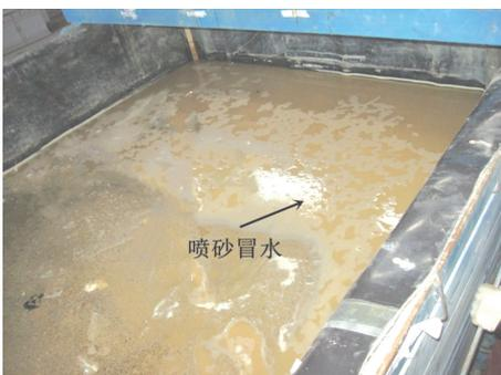
图 6 粉细砂完全液化
