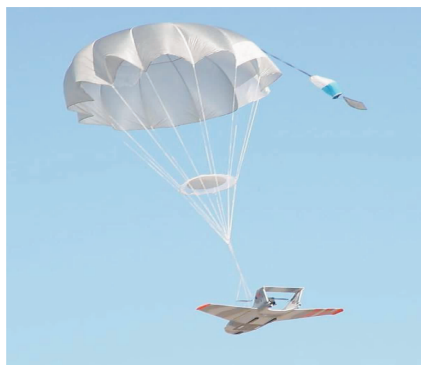
图 3 DRS 无人驾驶技术下的 BQM-34 Firebee 目标无人机降落伞回收
