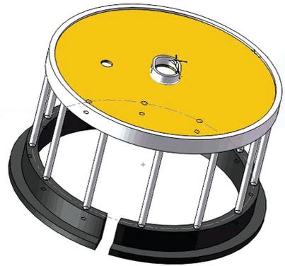
图 2 往复模块低温腔支架结构
