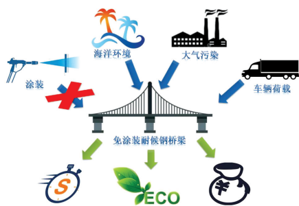
图 1 免涂装耐候钢桥梁的特点
