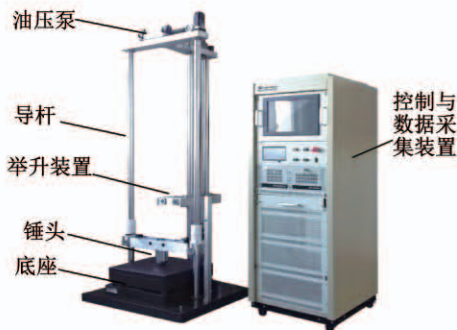
图 1 落锤冲击破碎实验机
