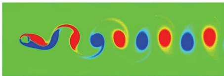
图5  $Re = 185$  时振荡圆柱流动稳定时涡量图
