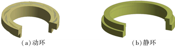
图 7 密封环结构示意图
