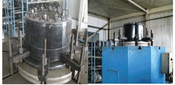
图 18 弯曲疲劳试验
