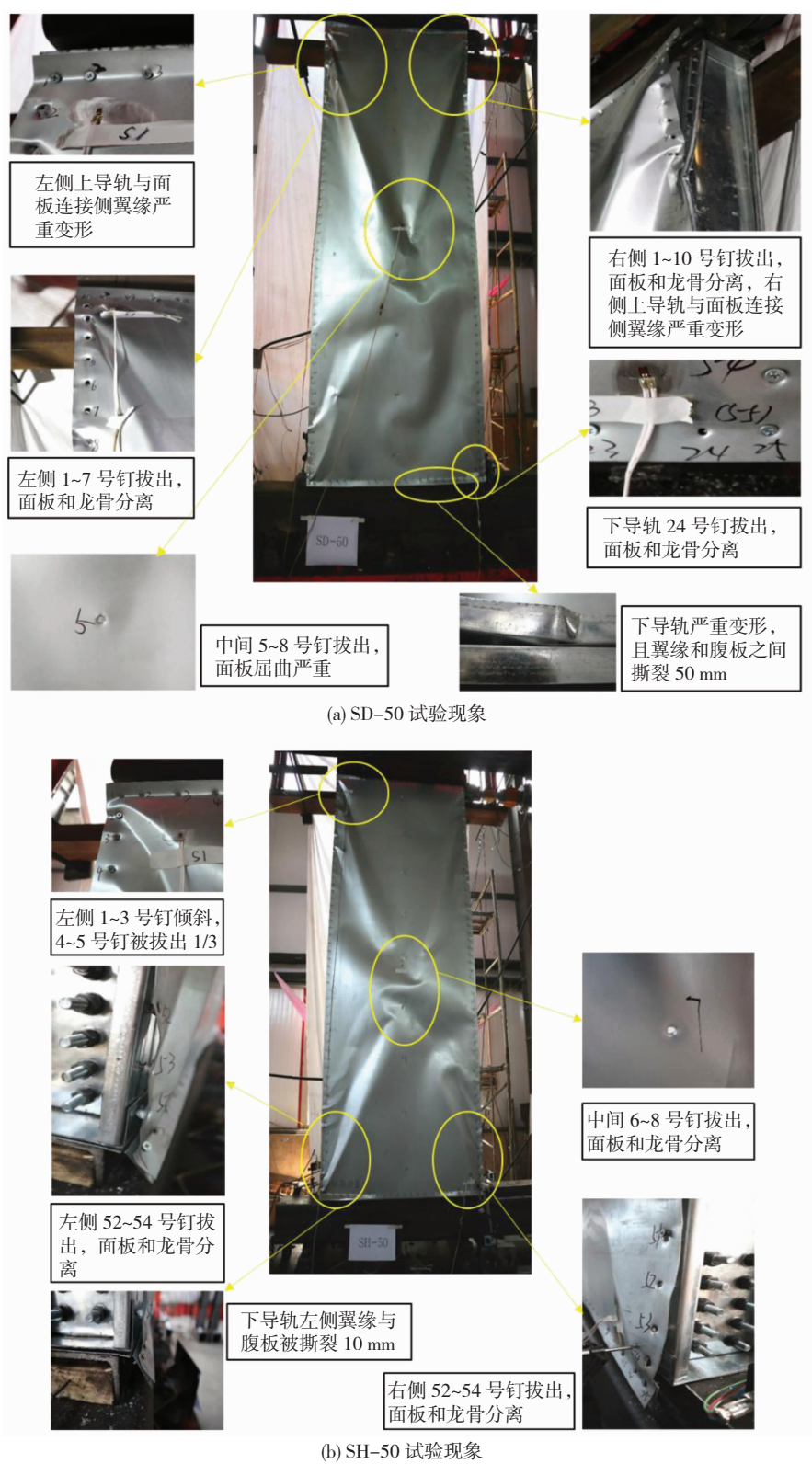
图 8 试件破坏现象
