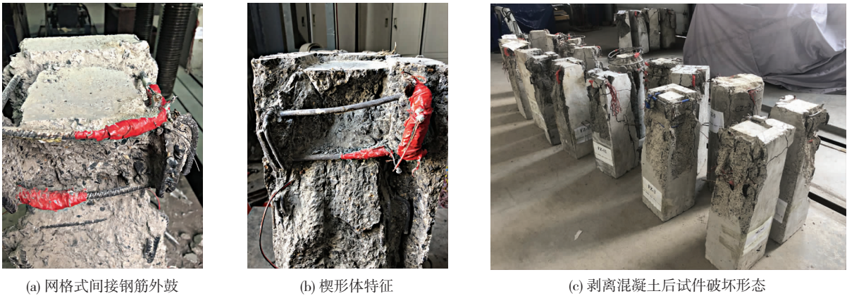
图 7 配置网格式间接钢筋的混凝土试件破坏形态和特征
