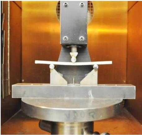
图 3 弯曲试验装置
