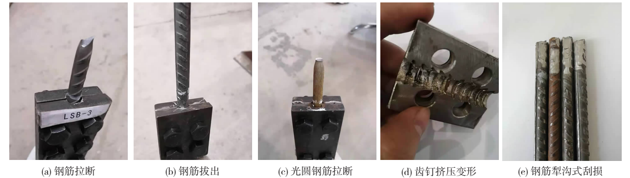
图 4 试件破坏模式 Fig. 4 Failure modes of specimens
