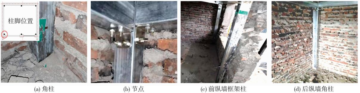
图 16 大震过后框架柱的试验现象
