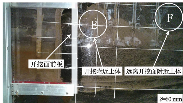
图7 渗流对黏粒的携带作用(试验 B-2)
