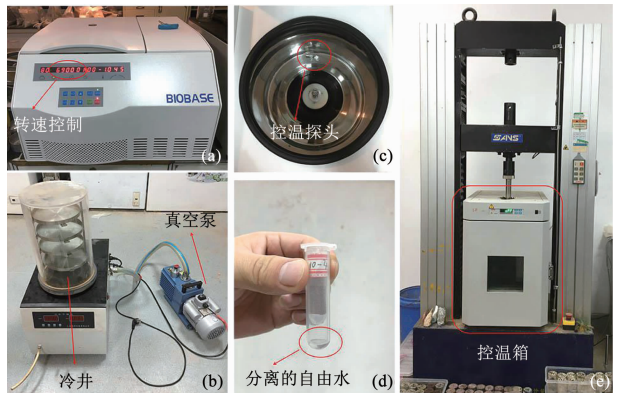
(a) 离心机; (b) 冻干机; (c) 离心腔; (d) 离心管; (e) 万能试验机
