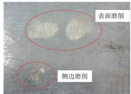
图 15 砂轮表面和侧边分别磨削 45 号钢板
