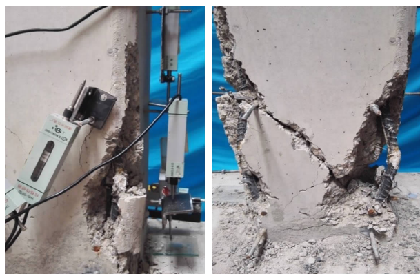
(a) 保护层发生破坏剥落 (b) 塑性铰纵筋屈曲
