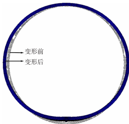
图15 焊接残余变形(变形放大20倍)
