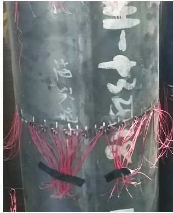
图10 测试完成的焊接圆钢管
