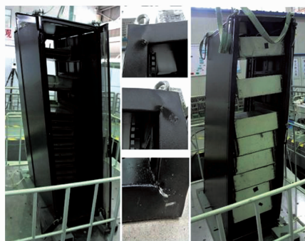
(d) 机柜破坏照片
