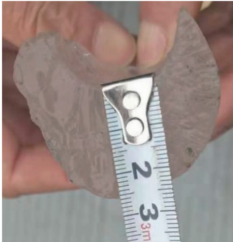
图 12 覆冰监测试验中脱落的冰块
