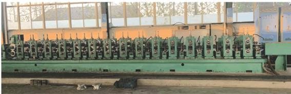
图 3 P 形管成形实际生产线
