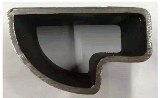
图 22 改进的辊弯成形工艺生产得到的 P 形管
