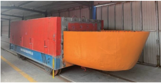
图 3 碰撞试验缩尺船艏模型实物照片 Fig. 3 Reduced-scale ship bow model of impact test
