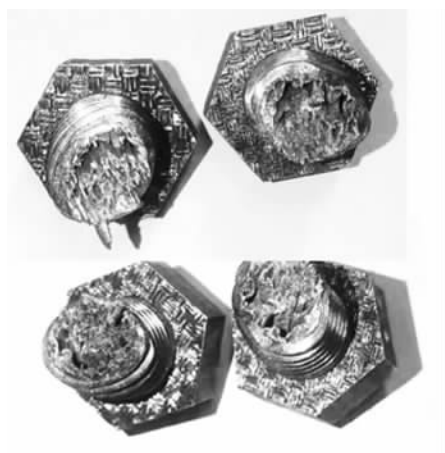
图 10 负泊松比螺栓破坏
