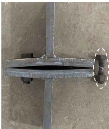
(a) ST1-A 螺栓破坏
