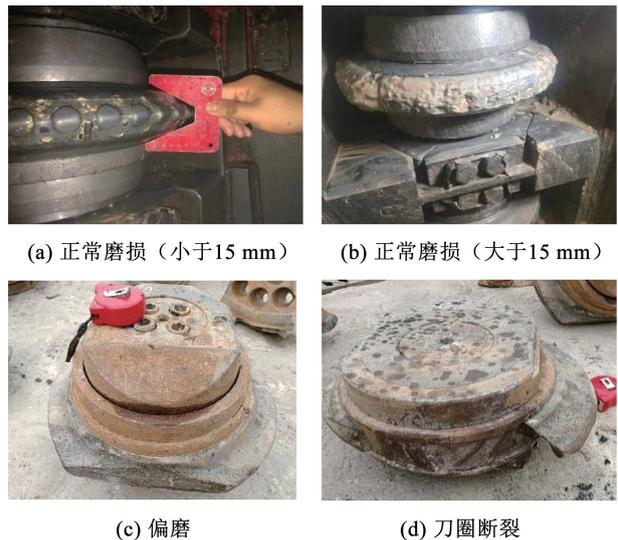
图 12 现场典型磨损刀具
