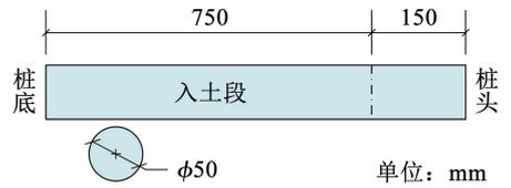
图 2 模型桩尺寸图
